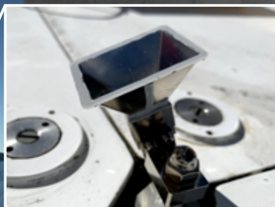
主鏡面に設置した 参照光放射器
